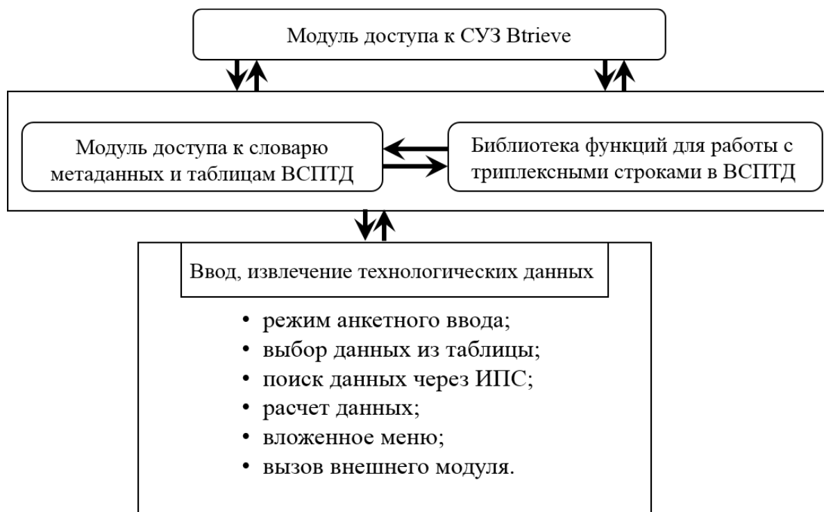
Рисунок В.1 – Схема взаимосвязи модулей ВСПТД
