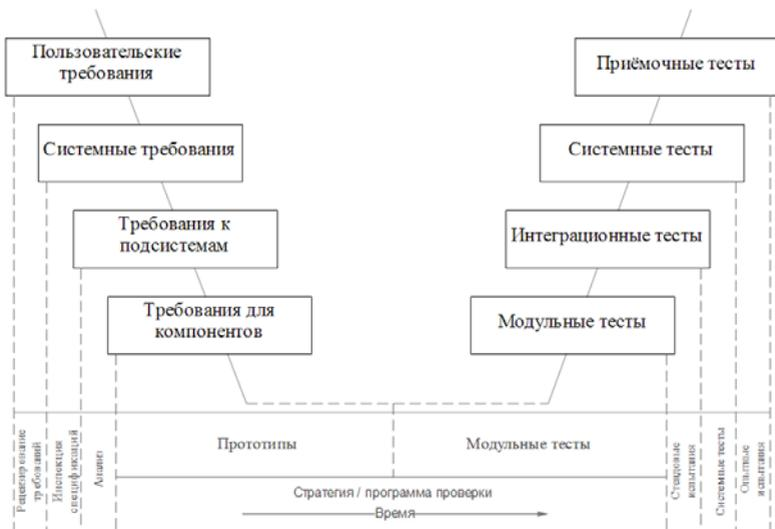
Рисунок 14 – Стратегия проверки системы в соответствии с циклом разработки [50]
