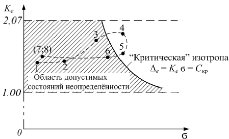
Рис. 8.5. Фрагмент энтропийного портрета состояния неопределенности температурного режима дефростационной камеры
