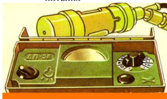
Рис. 6. Проверка работоспособности рентгенометра ДП – 5В
