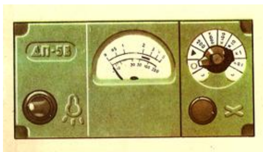
Рис. 3. Переключатель в положении 0 (выключено)
