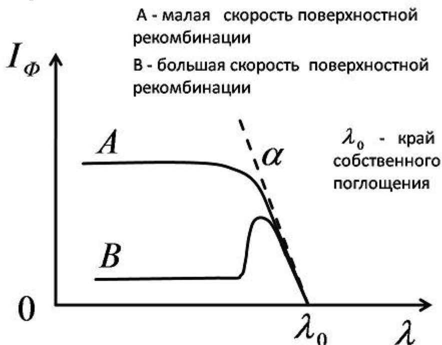
Рис 4. Зависимость фототока от длины волны для малых А и больших В скоростей поверхностной рекомбинации
