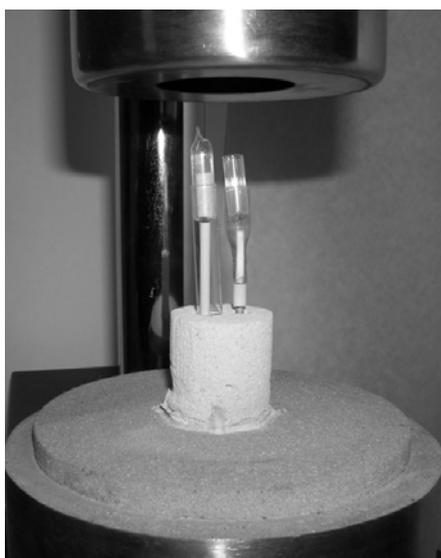
*Рис. 3.7 Размещение кювет с образцом и эталоном*
