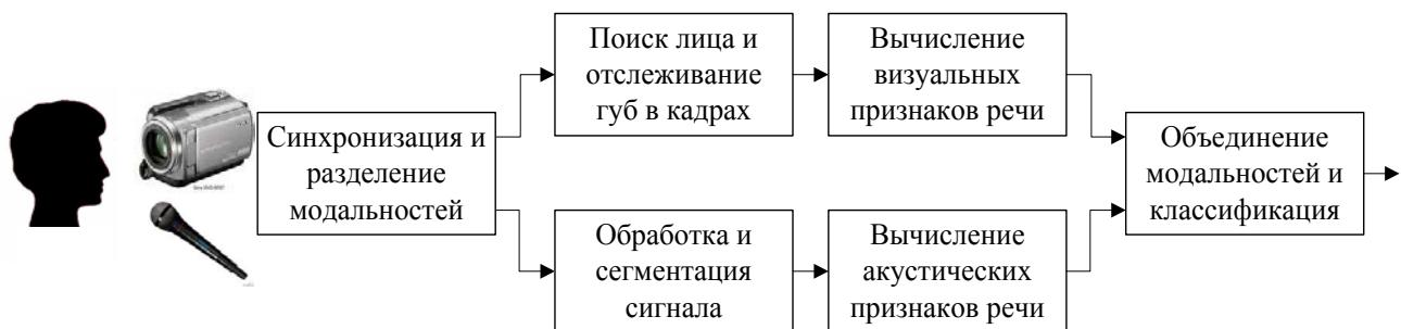
Рис. 16.3. Архитектура системы аудиовизуального распознавания речи.
