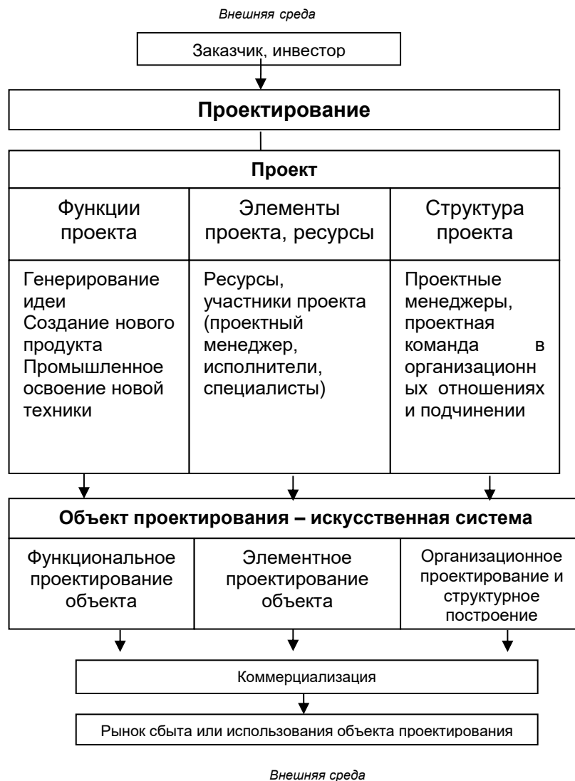
Рис 1.1. Системная модель проектирования
