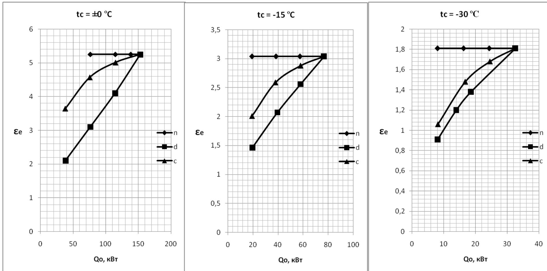
Энергетическая эффективность различных способов регулирования производительности компрессора:
