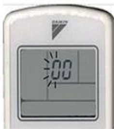
Рис. 1. Проверка значения первого символа кода неисправности
