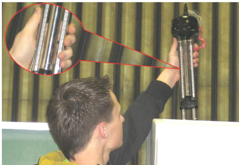
Рис. 1.2. Измерение температуры и влажности воздуха на входе во внутренний блок кондиционера
