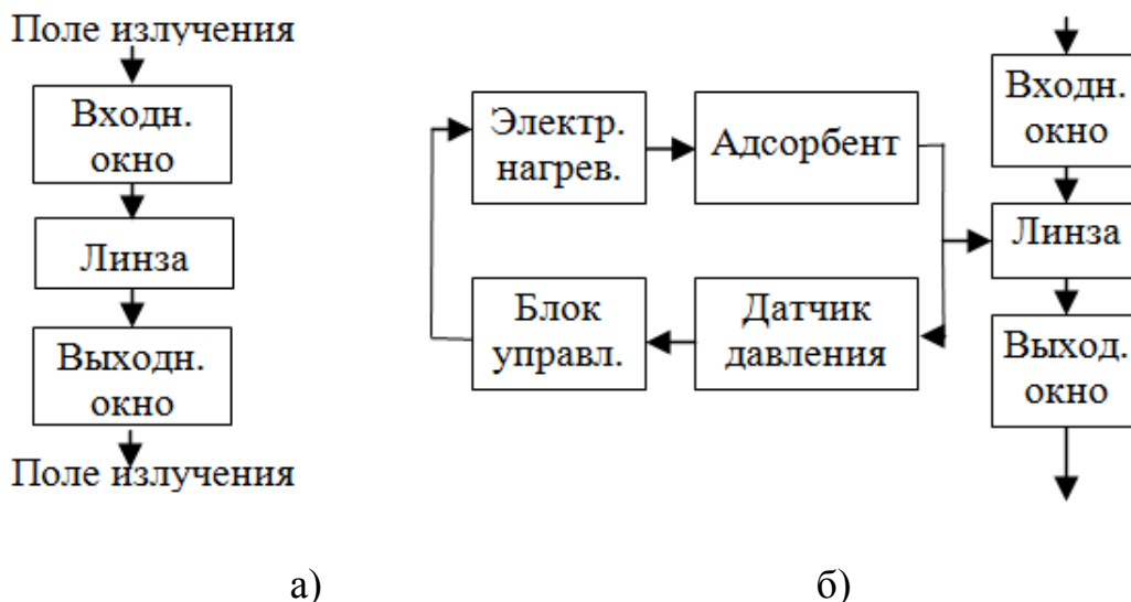
Рисунок 5. Проход линий а) сквозного излучения, б) пересечения
