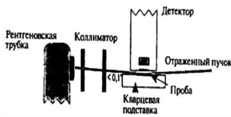
Рисунок 9.4.4 – Рентгено-флуоресцентный спектрометр многократного внутреннего отражения
