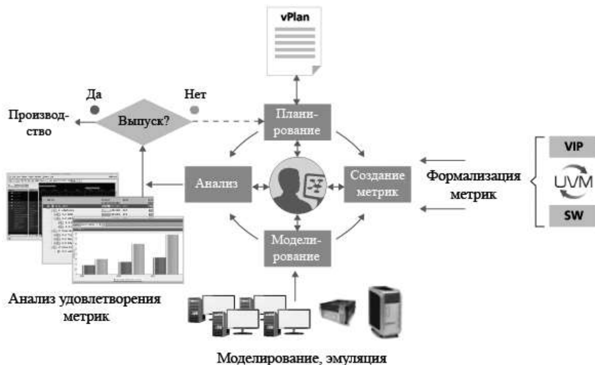
Рис. 27. Схема реализации технологии MDV в САПР фирмы Cadence.
