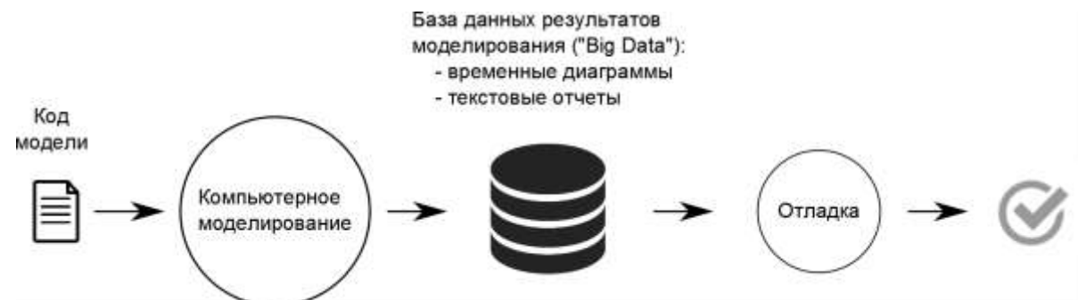
Рис. 25. Использование технологии работы с Big Data для поиска причин ошибок
