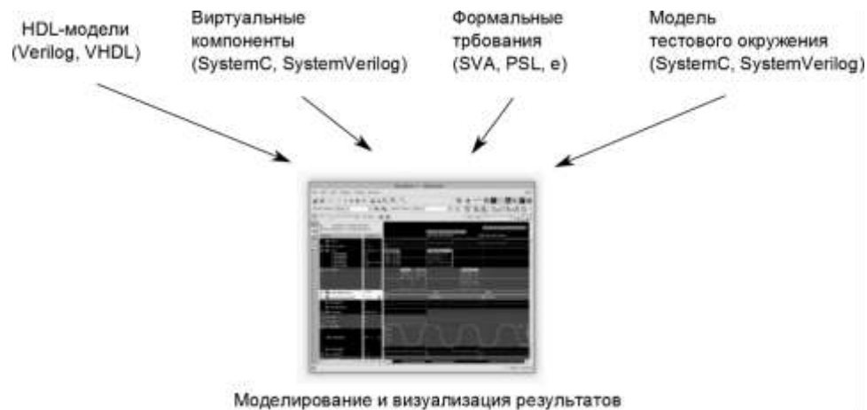
Рис. 22. Использование средств компьютерного моделирования для визуализации поведения разрабатываемой системы.
