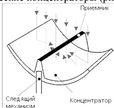
Рисунок 37 – Солнечный параболический концентратор
