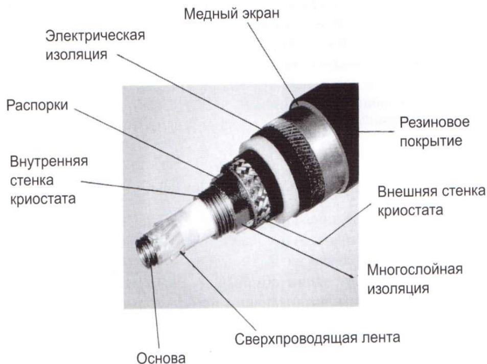
Рисунок 8 – Конструкция сверхпроводящего кабеля
