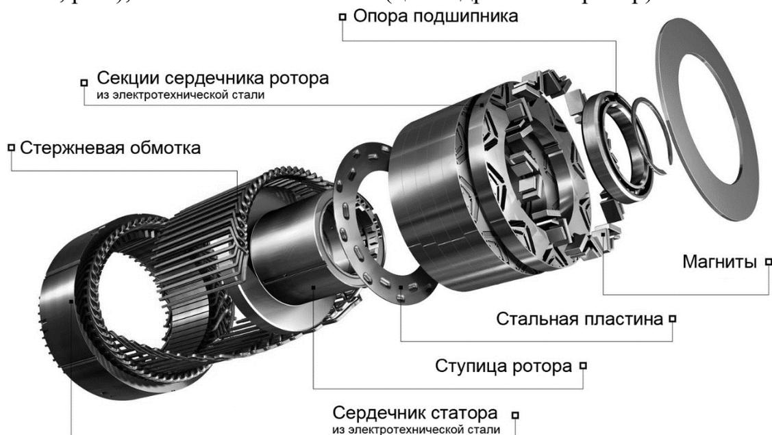
Рисунок 16 – Синхронный электродвигатель со встроенными постоянными магнитами
