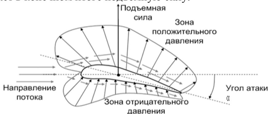
Рисунок 18 – Принцип подъемной силы на примере аэродинамического профиля
