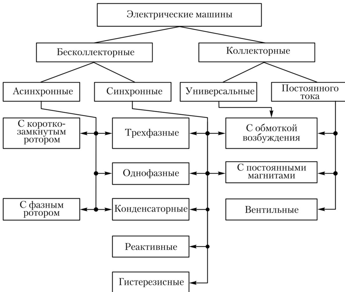
Рисунок 14 – Классификация электрических машин
