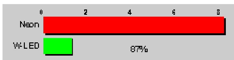
**Рис. 2.17. Сравнение затрат на электроэнергию при использовании светодиодов (красный цвет на рисунке) и неоновых трубок (зеленый цвет на рисунке)**
