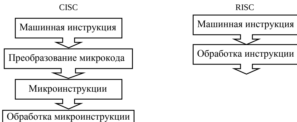
Рис.6.3. Сравнение CISC и RISC архитектур
