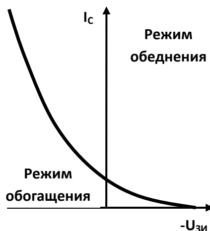
Рис.7.3. Сток-затворная характеристика МДП-транзистора со встроенным каналом
