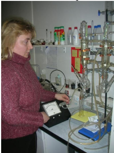
Рисунок 7. Установка для измерения содержания сероводорода в мазутах.
