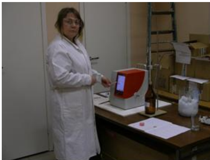
Рисунок 3а. Определение парциальных давлений компонентов нефти (нефтепродукта) по ASTM D 6378 на анализаторе EROVAP (США).
