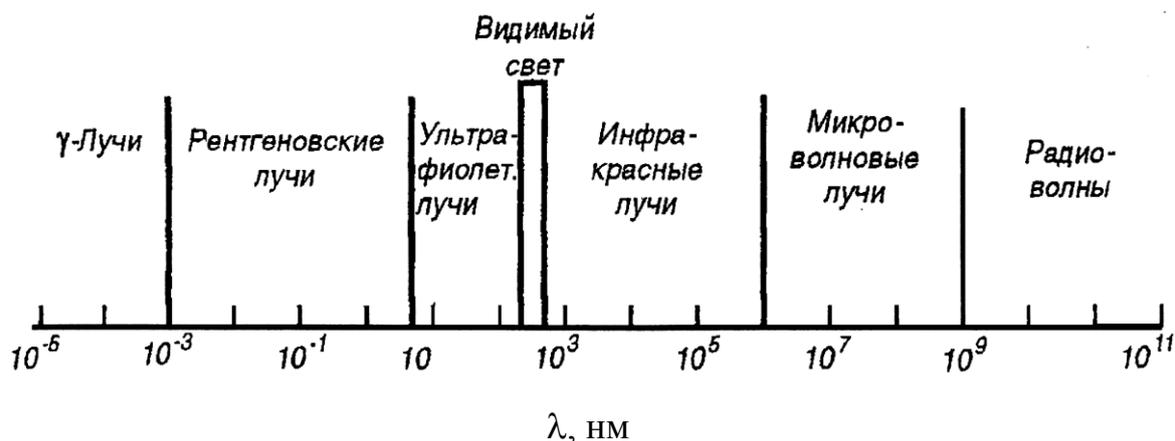
Рисунок 3.2 – Схема электромагнитного спектра
