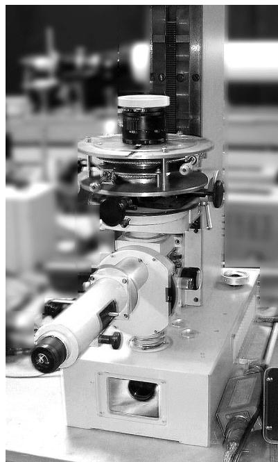
Рис. 51. Общий вид интерферометра Физо при контроле объектива
