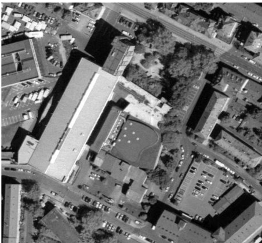
Рис. 4.10. Пример аэрокосмического изображения с тенями, которые могут использоваться для оценивания высоты зданий
