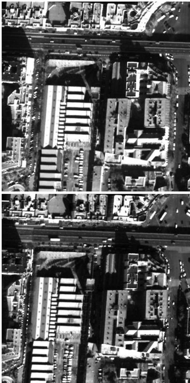
Рис. 2.8. Пример аэрокосмических снимков, взаимное геометрическое преобразование которых может быть описано как аффинное для объектов, находящихся на земле, с дополнительным полем локальных смещений для крыш зданий
