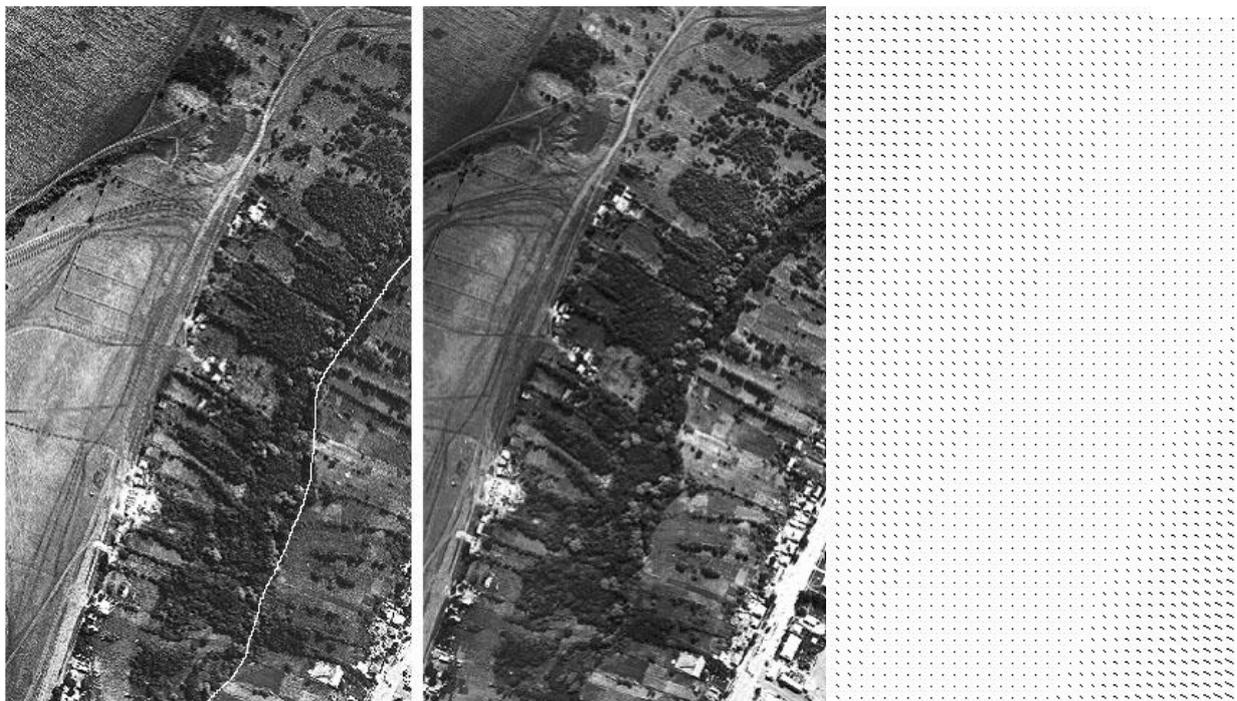
Рис. 2.18. Пример построения поля локальных смещений путем выполнения корреляции фрагментов, взятых вокруг набора точек, расположенных на регулярной сетке (белой линией отмечен овраг, по разные стороны от которого местность имеет разный наклон, что вызывает смещение соответствующих точек на изображениях, снятых с разных ракурсов)
