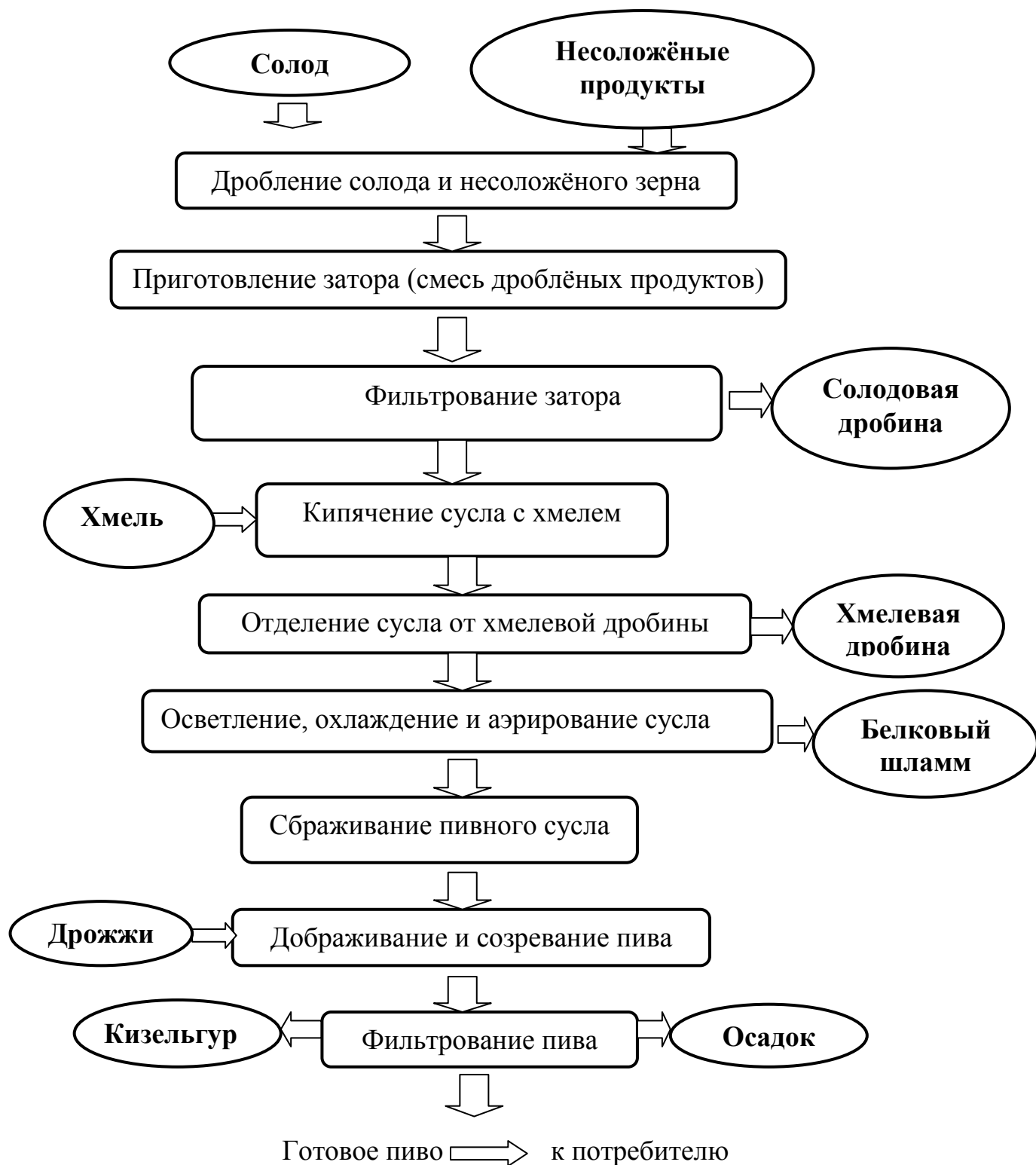
Рис. 4. Принципиальная технологическая схема производства пива
