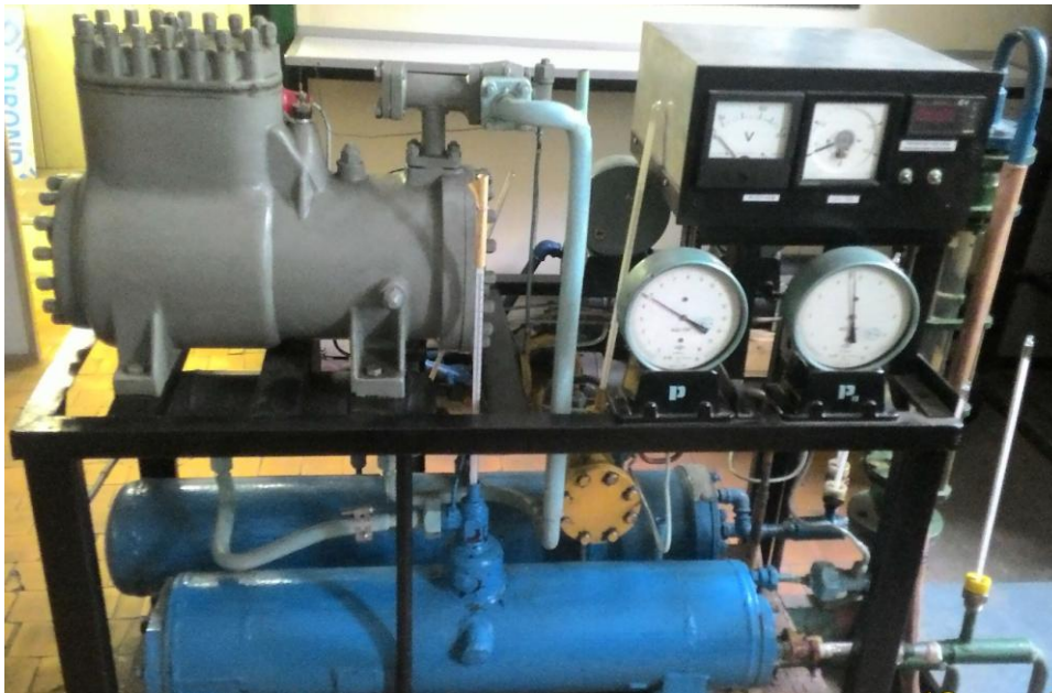
Рис. 6. Внешний вид одноступенчатой холодильной машины с регенеративным теплообменником
