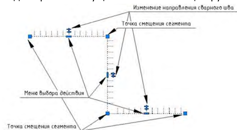
Рисунок 14.47 Сварной шов. Редактирование ручками
