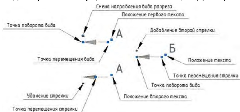
Рисунок 14.43 Вид и вид с дополнительной стрелкой. Редактирование ручками.
