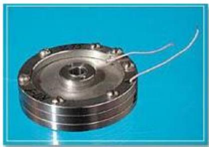
Корректор пьезоэлектрический Микроперемещений обладает большим быстродействием, безинерционностью, малой потребляемой мощностью.
