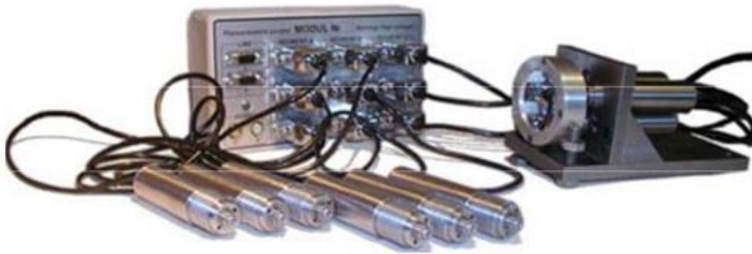
Рисунок 4.12 – Модуль управления адаптивного зеркала
