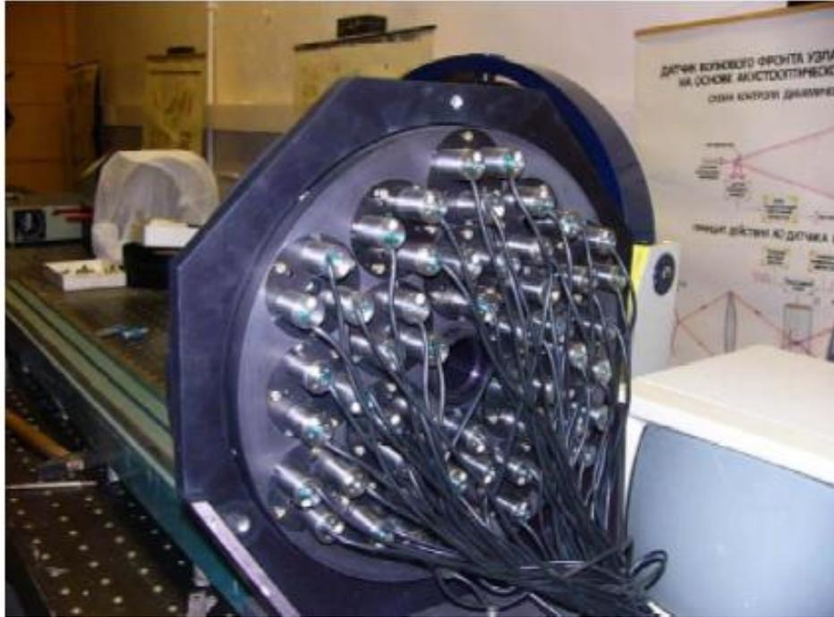
Рисунок 4.10 – Управление многосегментным адаптивным зеркалом
