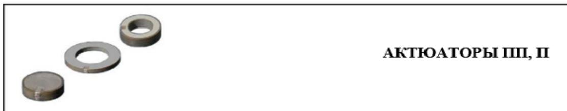
**Пьезопакетные актюаторы** изготавливаются путем сборки в пакет монокристаллических многослойных элементов с чередующимися керамическими и электродными слоями, ось пакета является осью линейного перемещения. При подаче напряжения толщина слоя увеличивается и соответственно увеличивается общая длина пакета.
