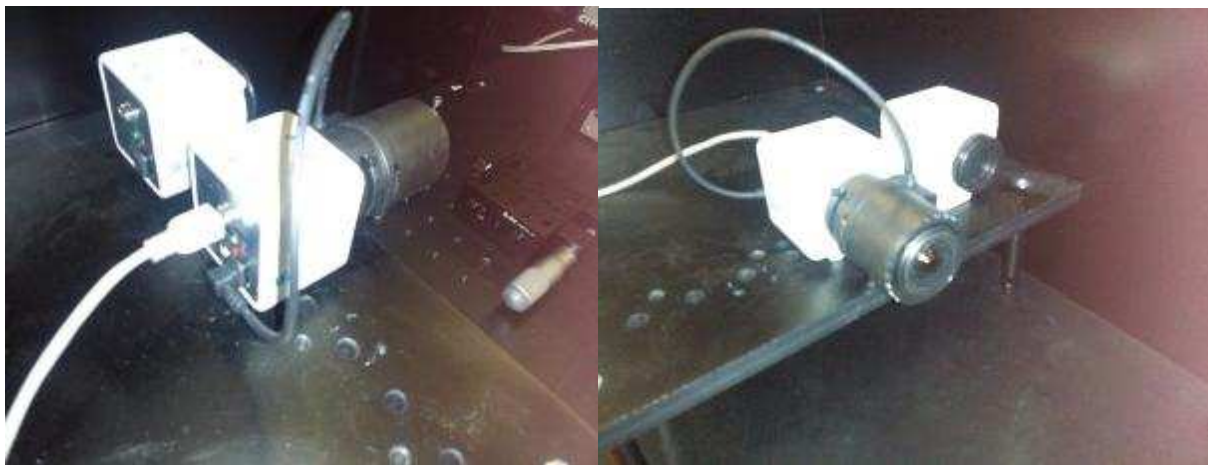
Рис. 1. Цифровая измерительная камера с объективом
