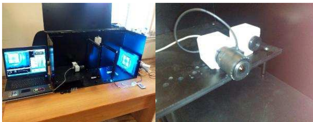
Рис. 5. Универсальный лабораторный комплекс и телевизионная камера, входящая в его состав
