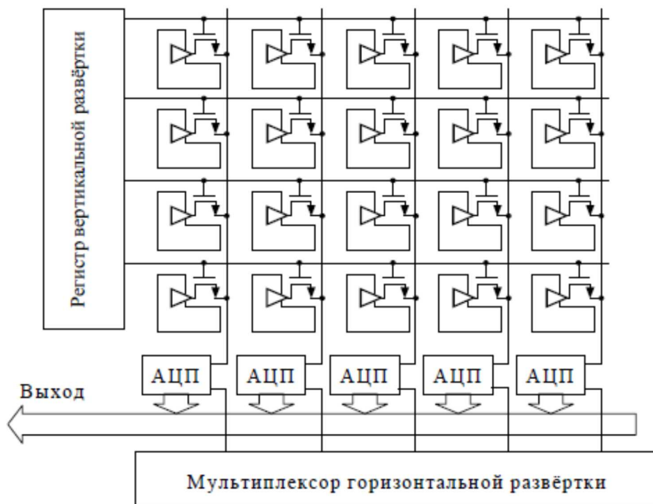
Рис. 3. Структурная схема КМОП-фотоприемника с активным пикселом и интегрированными АЦП [1]
