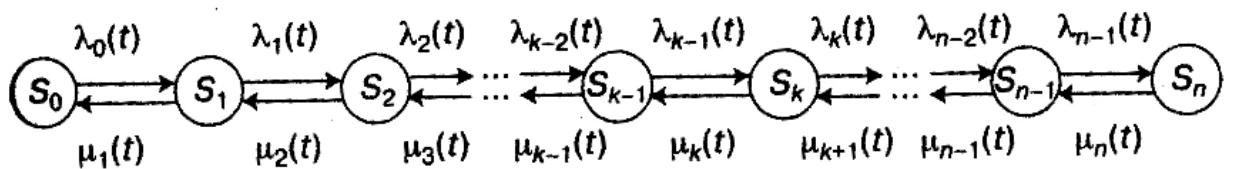
Рис. 5.1. Граф состояний для процесса гибели и размножения
