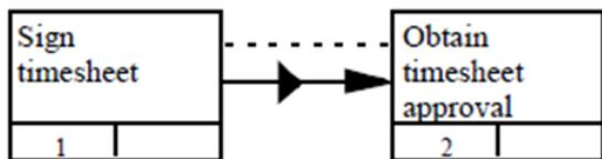
**Рис. 4.4. Пример относительной связи между UOB блоками**
