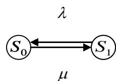
Рис. 6.1. Граф состояний одноканальной СМО с отказами
