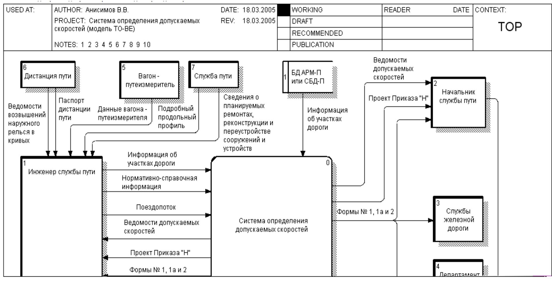
Рис. 3.2. Пример контекстной диаграммы DFD (в средстве моделирования BPwin)
