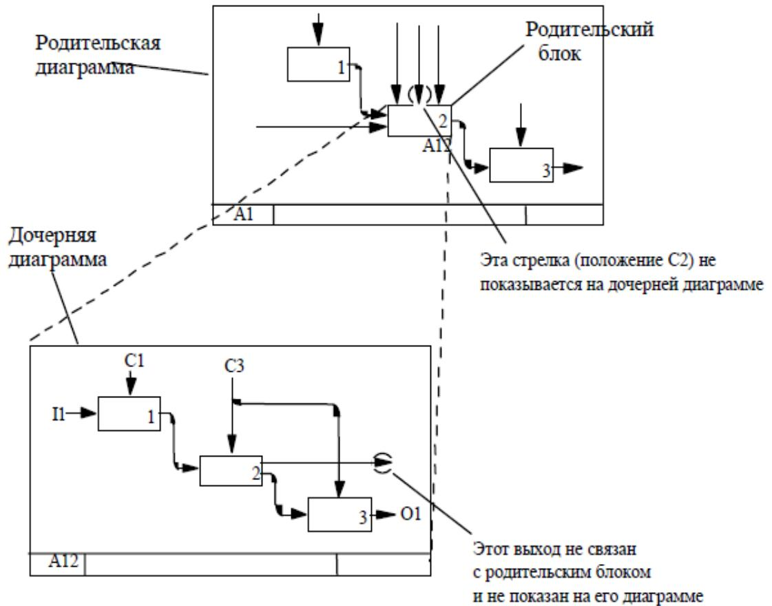
**Рис. 2.1. Пример использования туннельных стрелок на диаграммах**
