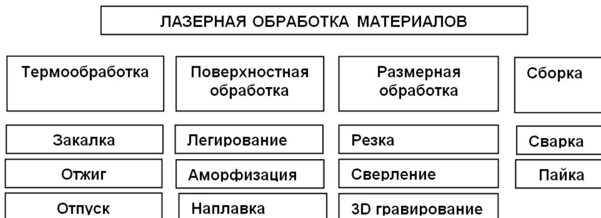
Рисунок 4.6. Технологические возможности современной лазерной обработки
