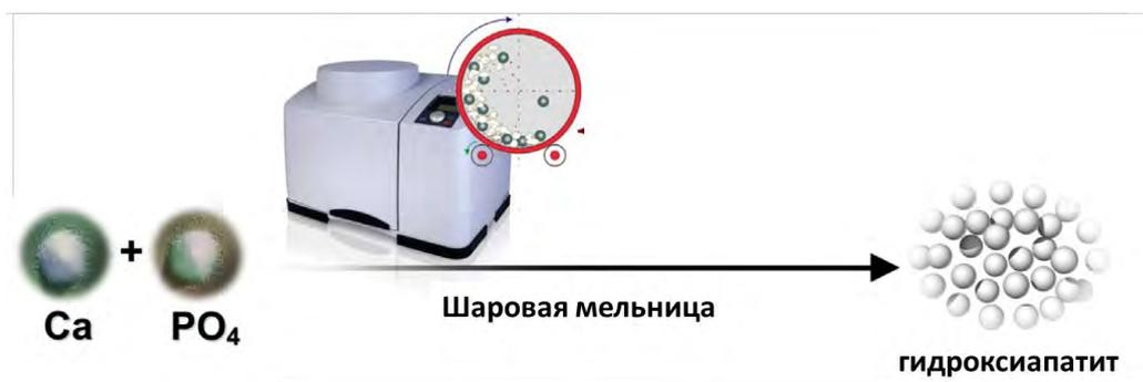
Рисунок 3.11 – Получение порошка гидроксиапатита с помощью механохимического метода [Sadat-Shojai M et al. // Acta Biomater (2013), V.9. №8. P. 7591-7621].
