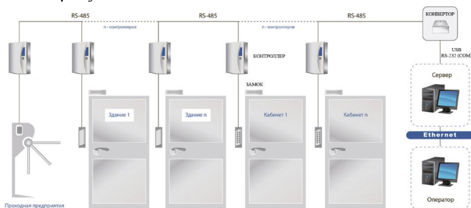
Рисунок 4 – Схема системы с линиями связи по интерфейсу RS-485
