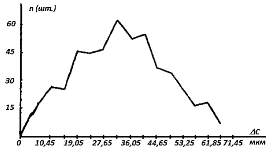
Рис.4.14. Эмпирическое распределение децентрировки линзы после завальцовки
