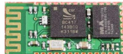
Bluetooth модуль на базе контроллера BC417
