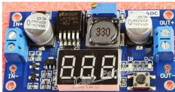
Преобразователь напряжения на базе микросхемы LM2596S
