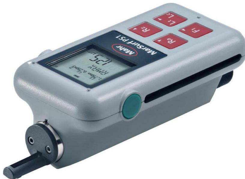
Рис. 1.21. Профилометр модели MarSurf PS1
