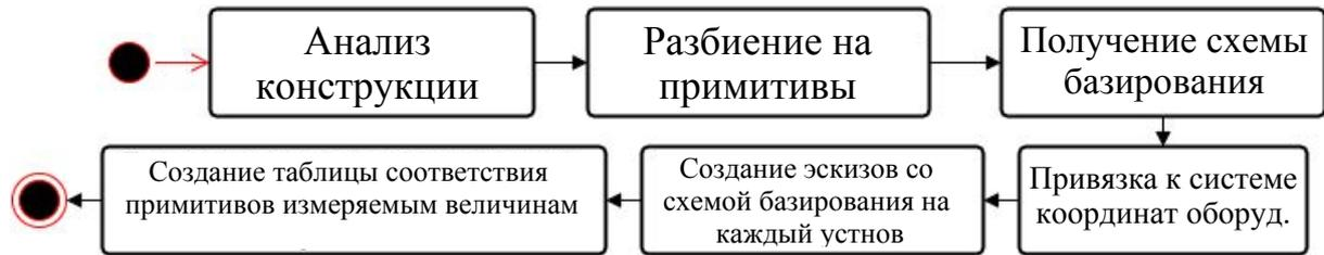
Рис. 1.10. Создание карты эскиза при контроле на КИМ
