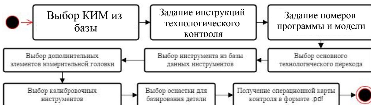
Рис. 1.9. Создание операционной карты при контроле на КИМ
