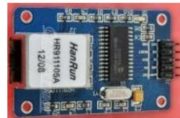
Ethernet модуль на базе контроллера ENC28J60
