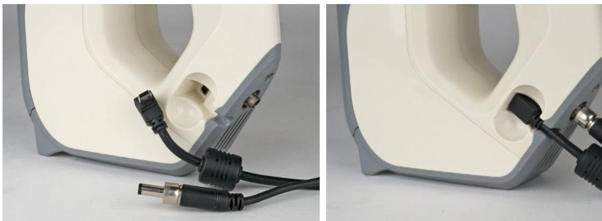
Рисунок 3.2. Подключение проводов к 3D-сканеру Artec Eva.
