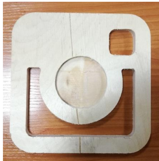
Рисунок 4.11. Установка начальной позиции фрезерования (а) и получаемая после фрезерования деталь (б).
