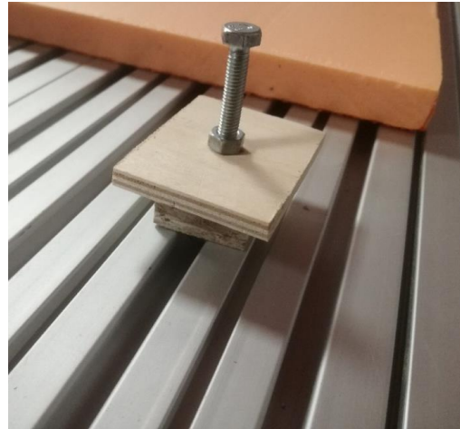
Рисунок 4.10. Место окончания зоны резки фрезера (а) и пример закрепления материала (б).
