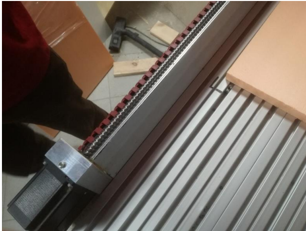
Рисунок 4.10. Место окончания зоны резки фрезера (а) и пример закрепления материала (б).
