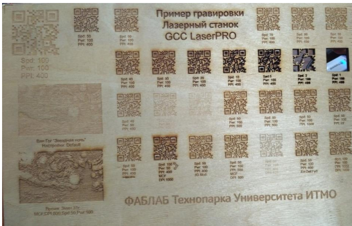
Рисунок 2.6. Образец с различными настройками режимов гравировки на фанере.
