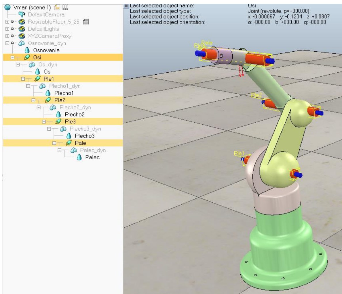
Рисунок 38 – Иерархия объектов и расположение шарниров манипулятора
