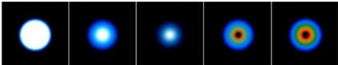
Рис. 8.21. Цветные каёмки, наблюдаемые при наличии хроматической абберрации.
