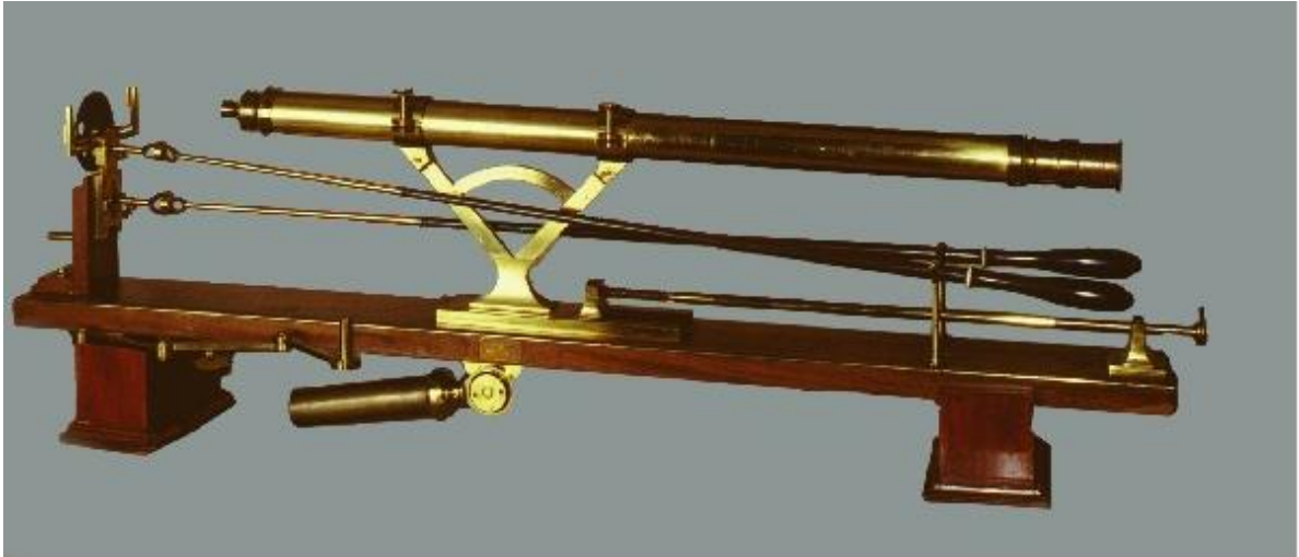
Рис. 3.6. Телескопический ахроматический микроскоп Эпинуса (1805–1808).
