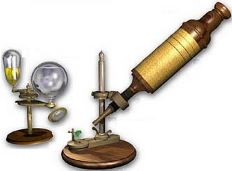
Рис. 2.8. Микроскоп Гука с осветительной системой, созданный им около 1670 г. (реконструкция микроскопа по рисунку Гука).
