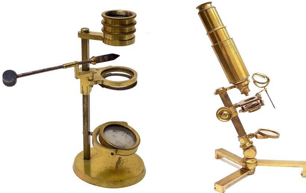
Рис. 2.1. Простой (слева) и сложный (справа) микроскопы.
