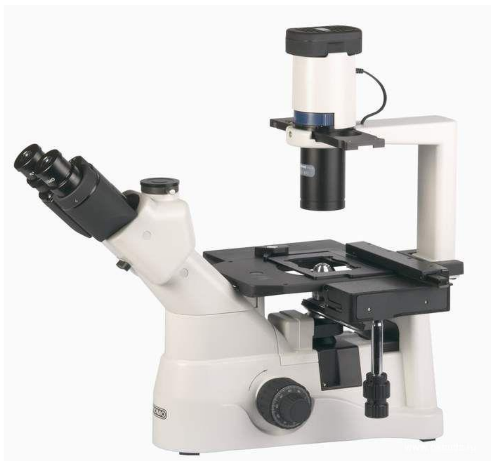
Рис. 9.12. Инвертированный микроскоп МИБ-Р фирмы ЛОМО. Объективы расположены снизу, конденсор и лампа проходящего света — сверху.
