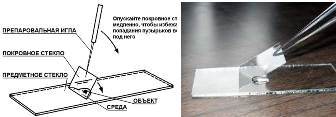
Рис. 10.9. Подготовка препарата с покровным стеклом.
