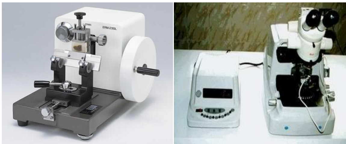
Рис. 10.17. Большой роторный микротом (слева) и ультрамикротом (справа).
