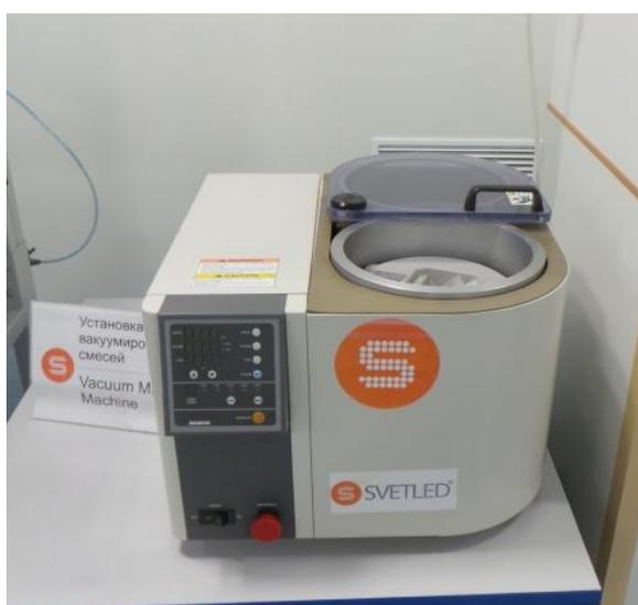
Рисунок 38 – Вакуумный смеситель (Центрифуга)
