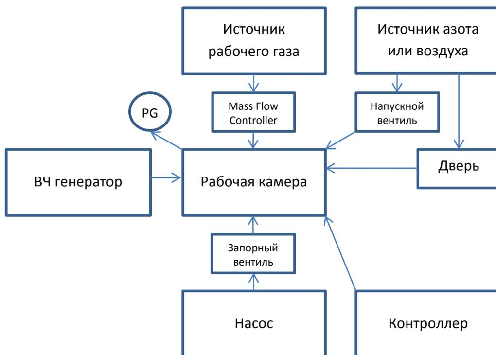
Рисунок 16 – Схема установки плазменной очистки
