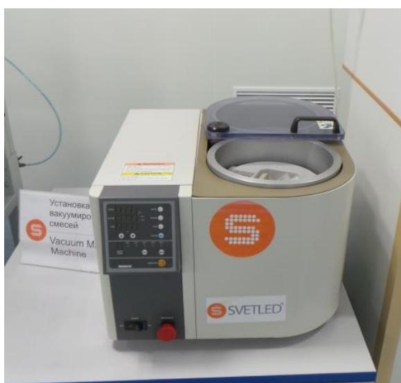
Рисунок 38 – Вакуумный смеситель (Центрифуга)
