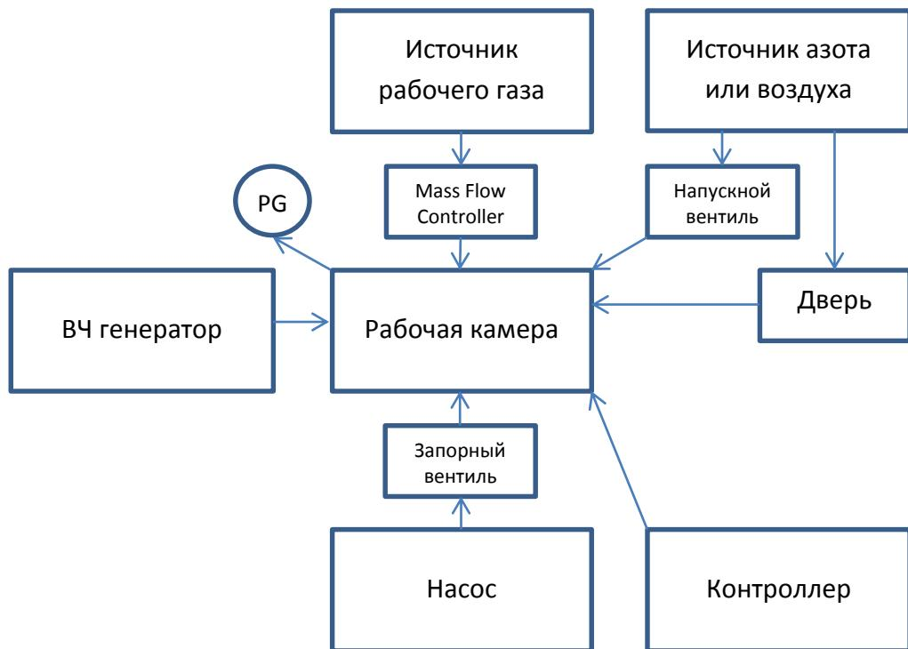
Рисунок 16 – Схема установки плазменной очистки
