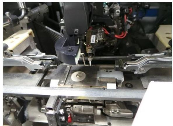
*Рисунок 33 – Фото установки сварки проволочных контактов iHawk*
