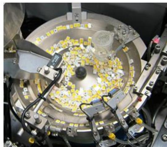
Вибробункер со светодиодами
