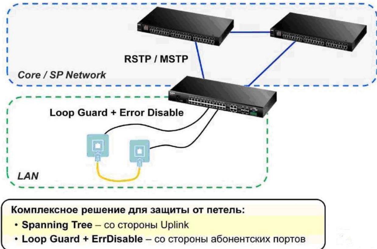
Рис. 24. Схема работы функции защиты от петель
