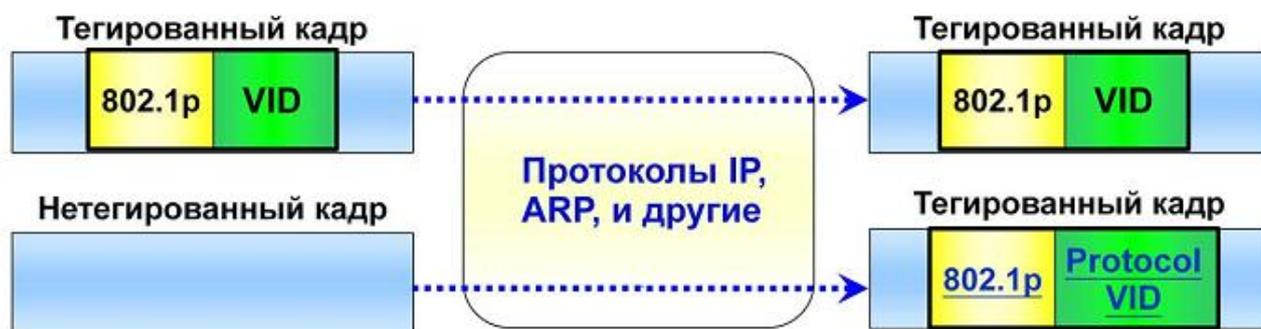
Рис. 9. Работа входного правила на базе протокола
