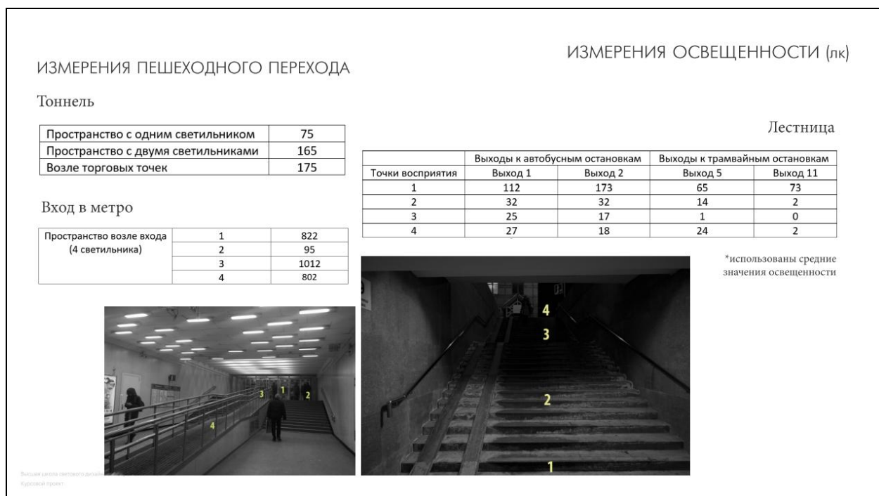
Рис. 45 – Исследование световой среды. Измерение освещенности пространства подземного пешеходного перехода.
