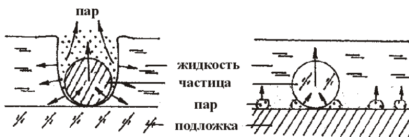
Иллюстрация физического механизма влажной лазерной очистки (при температуре кипения воды).
