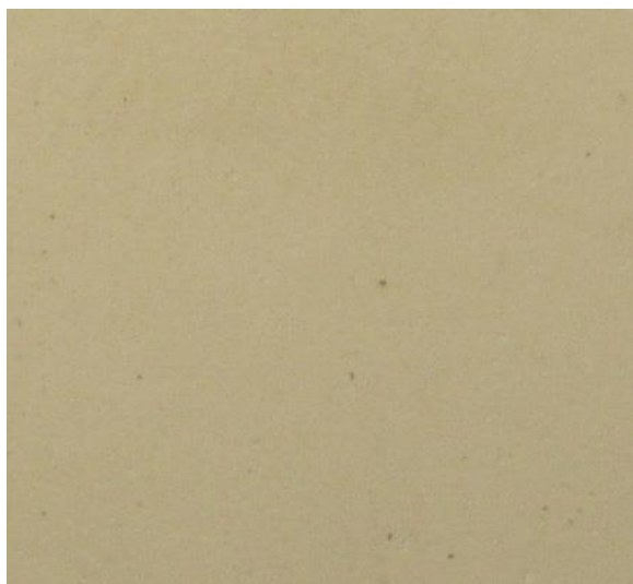
Фотография исходная пластина ситалла СТ-50-1 ( \text{TiO}_2\text{-SiO}_2 , \text{Al}_2\text{O}_3 , \text{CaO} , \text{MgO} ) (в отраженном свете)
