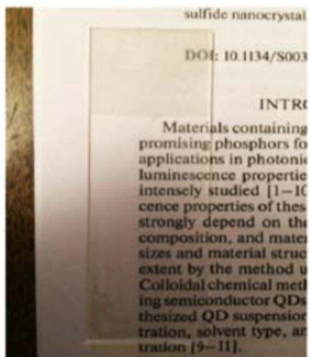
Рисунок 11 – Фотография стеклянного образца с нанесенным на его поверхность бактерицидным \text{TiO}_2\text{-MgO} покрытием
