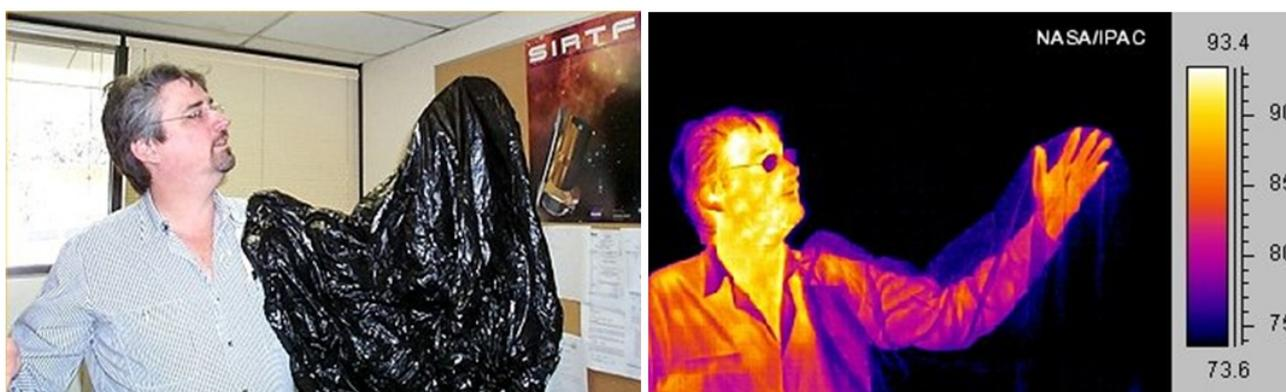
Рисунок 2.8 - Иллюстрация фирмой Sofradir пропускания видимого и ИК излучения полиэтиленовой плёнкой (из рекламных материалов фирмы Sofradir)
