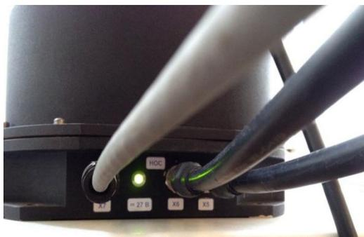
Рис. 6.2. Подключенные антенные кабели (X5 и X6) и кабель питания к СНС-компасу
