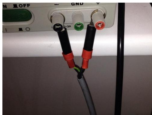
Рис. 6.7. Подключение кабеля питания (X7) СНС-компаса к источнику питания
