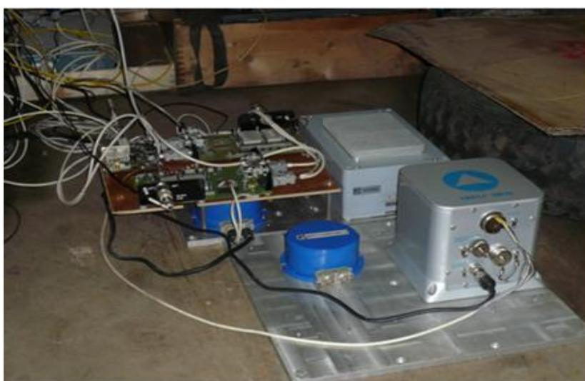
Рис. 3.1.4 Внешний вид модулей приемовычислительных ПА СНС в системе
