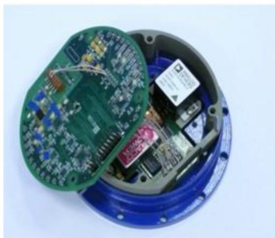
Рис. 3.1.1. Бескарданный ИИМ (ф. «Электроприбор») с ИБ на ММД (ф. Analog Devices)
