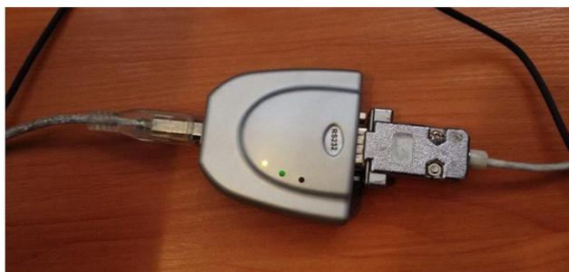
Рис. 6.4. Соединение кабель-адаптера с кабелем информационного обмена СНС-компаса (X2)
