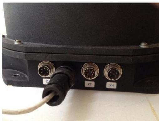
Рис. 6.3. Подключенный кабель информационного обмена к СНС-компасу
