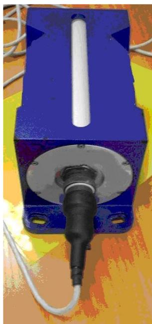
Рис. 6.15. Внешний вид измерительного блока СНС-компаса «ИСОН-2»
