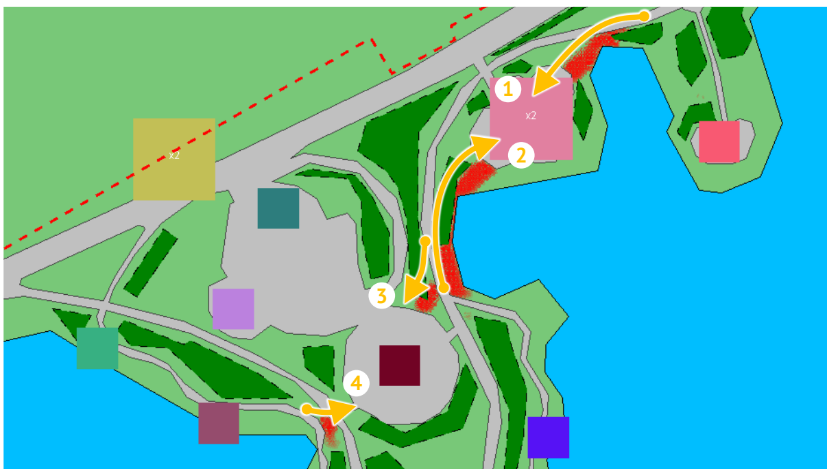
Рисунок 53. Отсутствуют входы на площадки с углов (1, 2, 3), не соединяются близко идущие дорожки (4)
