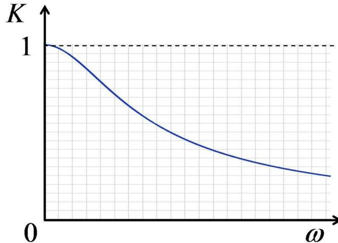
Рис.4. Зависимость коэффициента передачи по амплитуде от частоты для  $RL$ - цепи.
