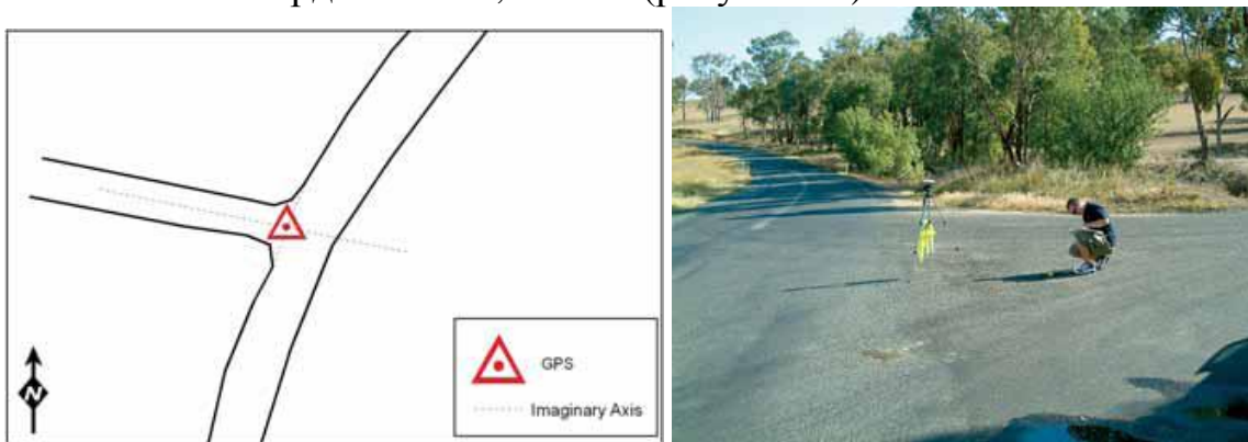
Рисунок 58. Схема планового положения и фотография наземной опорной точки на местности
