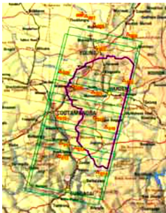
Рис. 61. Местоположение наземных опорных точек, которые использовались для фототриангуляции
