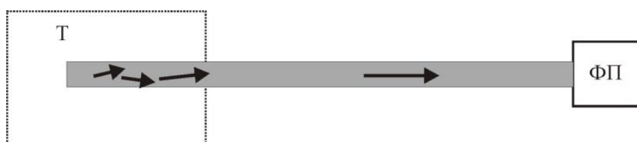
Рисунок 4.4 - Схема волоконно-оптического датчика для измерения температуры на основе генерации теплового излучения в волокне
