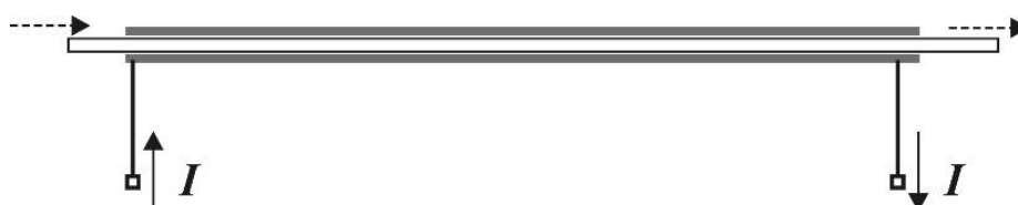
Рисунок 4.3 - Плечо интерферометра Маха-Цендера для измерения силы электрического тока
