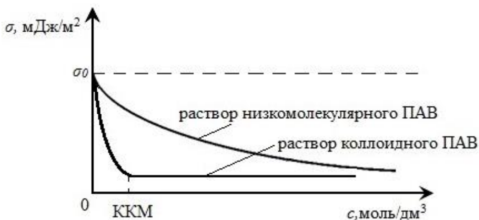
Рисунок 1 – Изотермы поверхностного натяжения – зависимости поверхностного натяжения на границе водный раствор ПАВ – воздух от молярной концентрации ПАВ ( \sigma_0 – поверхностное натяжение чистого растворителя)
