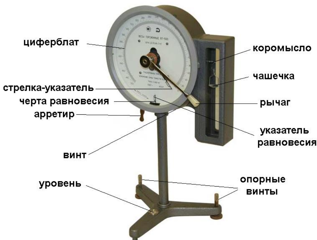
Рисунок 7 –Торсионные весы ВТ – 500
