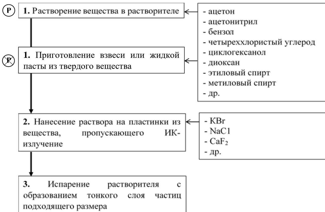
Рисунок 5.3 – Схема метода осадочных пленок для растворимых и нерастворимых соединений
