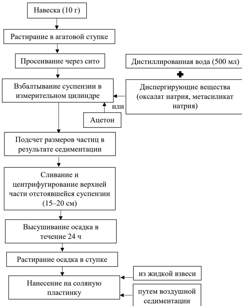
Рисунок 5.4 – Схема метода седиментации
