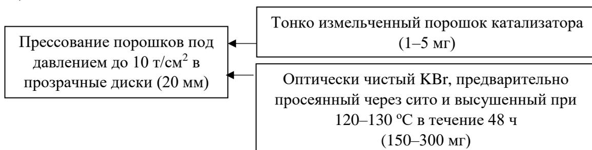
Рисунок 5.5 – Схема метода прессования
