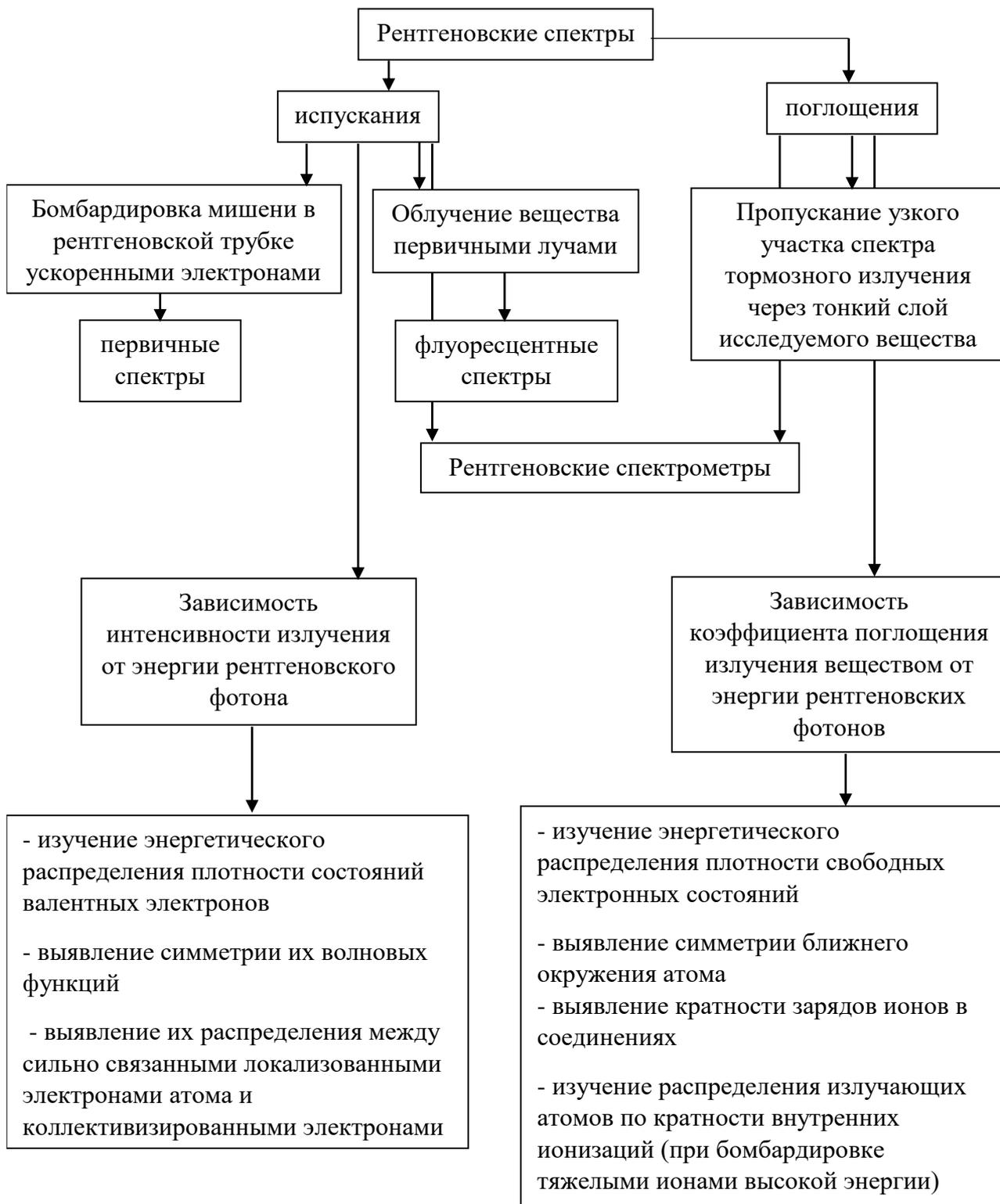
Рисунок 3.14 – Схема получения рентгеновских спектров
