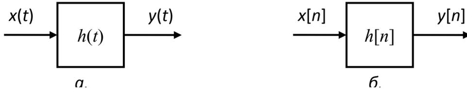
Рисунок 2. а. – аналоговая система; б. – цифровая система
