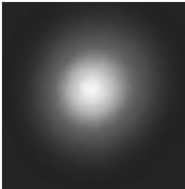
Рис. 52 . Дальнепольное распределение интенсивности на поверхности приемника изображения
