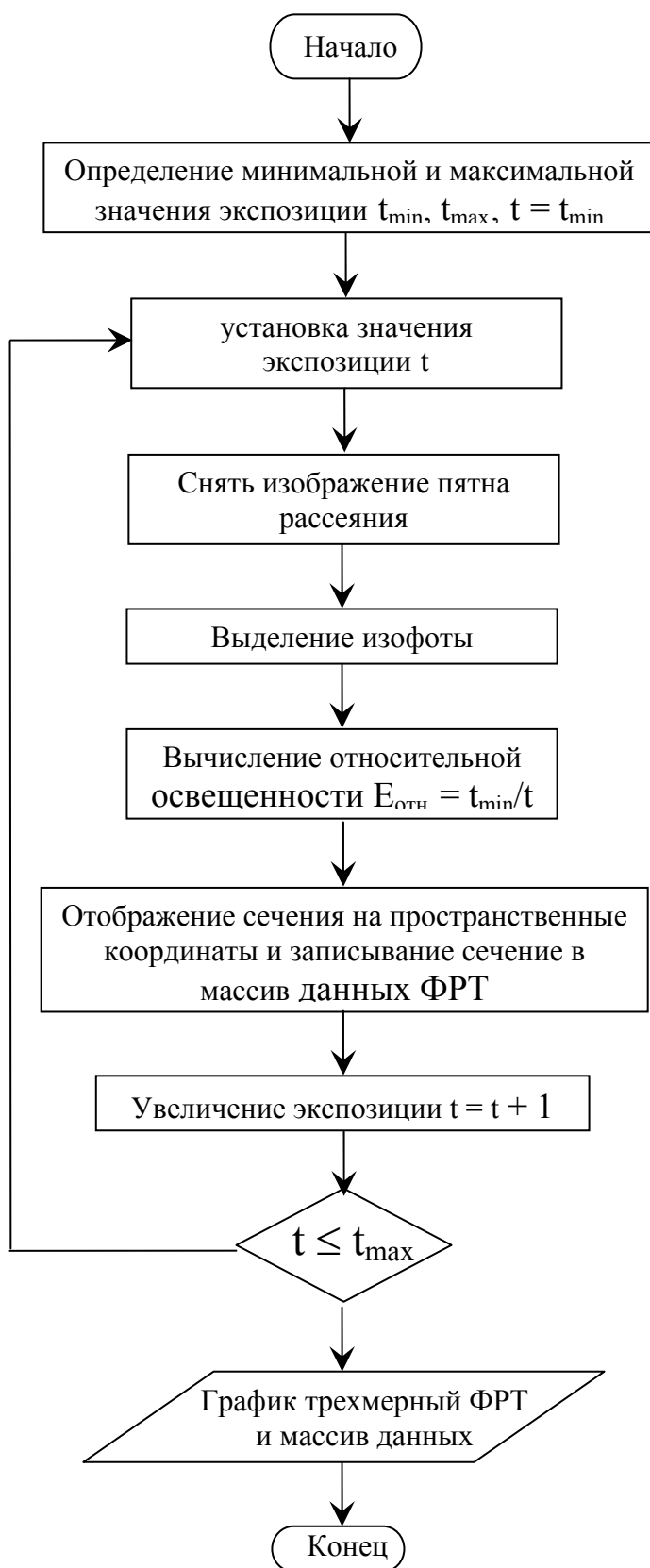
Рис 18. Алгоритмическое решение компьютерной версии изофотометрии с переменным накоплением при помощи USB – камеры, управляемой компьютером.
