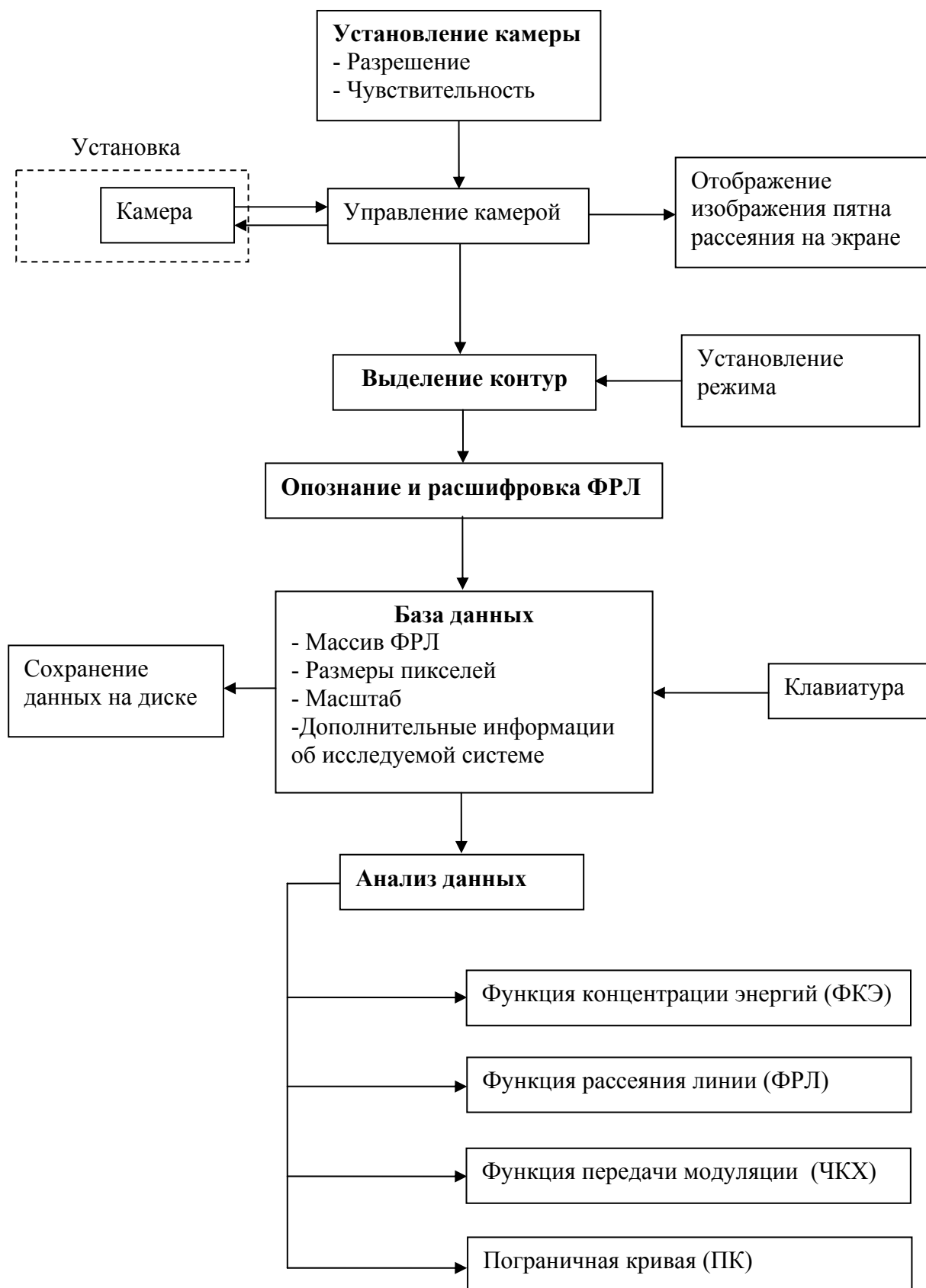
Рис. 43. Структурная схема программы КИЗО-ФРЛ
