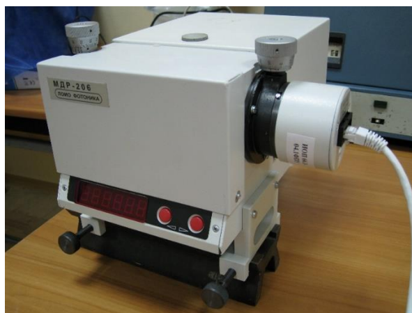
Рисунок 1.3 – Внешний вид монохроматора МДР-206
